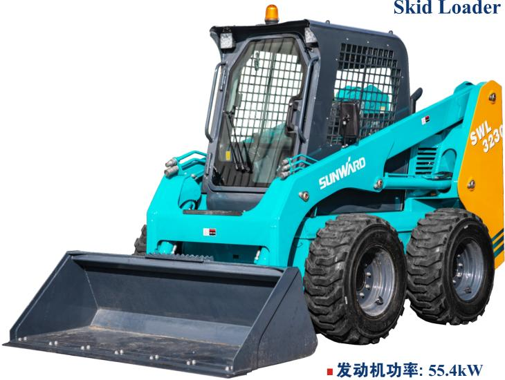
■发动机功率: 55.4kW Engine power
